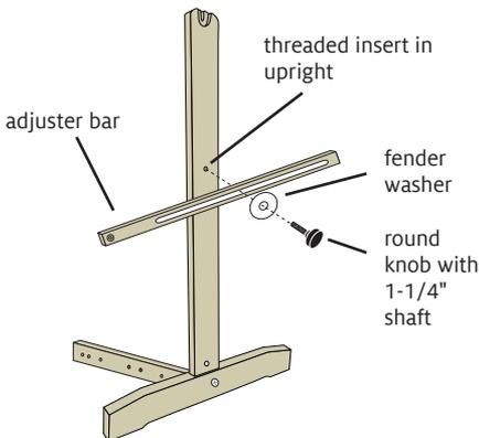
FIGURE 4: ATTACH ADJUSTER BARS TO THE UPRIGHTS
